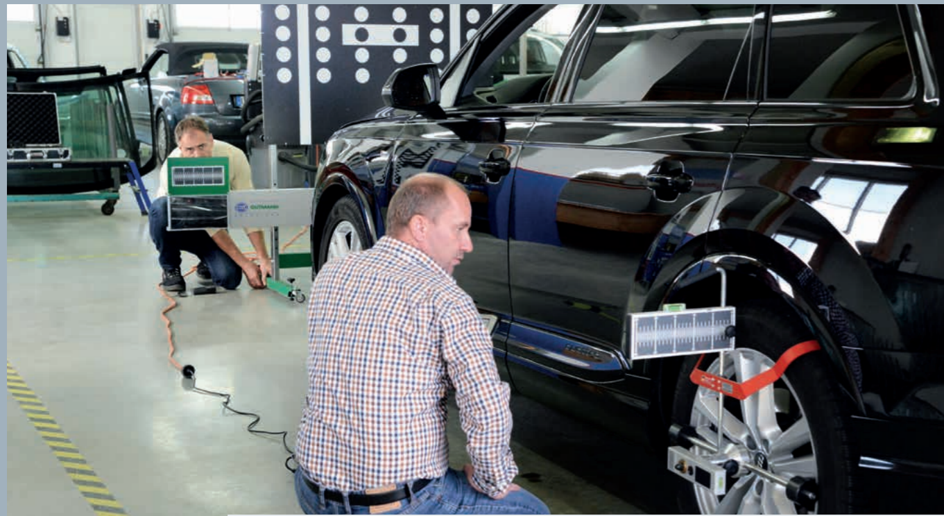
Höchster Genauigkeitsanspruch: Im Rahmen einer genau definierten, vom mega macs geführten Vorgehensweise werden die FAS-Sensoren mit dem CSC-Tool stets auf die geometrische Fahrachse (Hinterachse) ausgerichtet.
