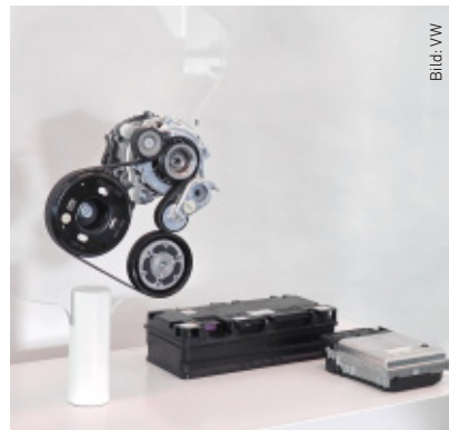
Die Kernkomponenten des 48-Volt-Mild-Hybrid im kommenden VW Golf VIII: RSG, 48-Volt-Akku und DC/DC-Wandler.
