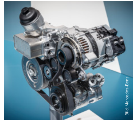
Mercedes setzt im neuen 4-Zylinder-Ottomotor (M254) auf einen RSG, der im Drehzahlbereich bis 2.500/min bis zu 10 kW Zusatzleistung liefert.
