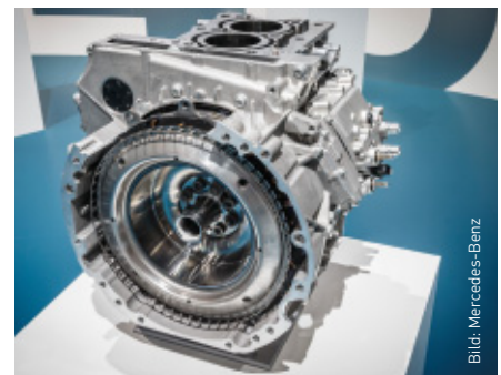
Auf der Kurbelwelle des 3-Liter-6-Zylinder-Ottomotors (M256) montiert Mercedes einen integrierten Startergenerator (ISG).
