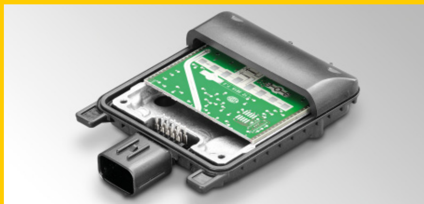
In Heck-Stoßfängern verbaute HELLA-Radarsensoren liefern Messdaten für fünf unterschiedliche FAS.
